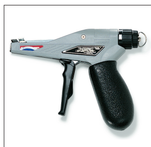
För användare av stora volymer finns appliceringsverktögen MK7 (manuell) eller MK7P (pneumatisk) – båda verktögen garanterar jämn åtdragningskraft med inställbart moment. Lämnar inga vassa kanter efter att svansen är avklippt.
