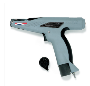
För användare av stora volymer finns appliceringsverktögen MK7 (manuell) eller MK7P (pneumatisk) – båda verktögen garanterar jämn åtdragningskraft med inställbart moment. Lämnar inga vassa kanter efter att svansen är avklippt.
