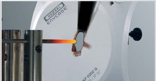
Brännbarhetstest glödtrådsprovning 960 °C Hög slagtålighet IK 09 (10 Joule)
