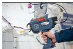
Autotool CPK hybrid med nättaggregat och upphängd i ett upphängningsstativ.
