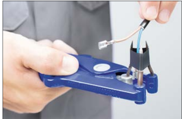
Snabb, säker applicering med det trespetsade expanderingsverktyget.
