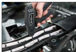
Buntbandet kan klippas av på valfritt ställe av bandet.
