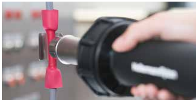
Varmluftspistol utrustad med reflektor för jämn värmespridning.
